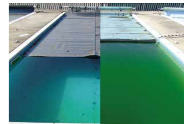
obr. 3 Zložený obrázok hore (obr. 3) ukazuje bazén zakrytý plachtou EnergyGuard™ Selective Transmission (L) a priehľadnou plachtou (P) počas zimy.
